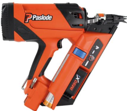
Bei Einsatz des Impulse Streifennaglers IM90Xi sind Nagelschrauben 2,8/3,2x50 mm aus Edelstahl 1.4301 (Paslode Bestell-Nr. 142101) für die Befestigung der Cedral Lap Fassadenpaneele zu verwenden.
