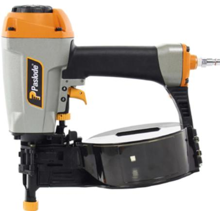
Wird der Paslode Druckluft-Coilnagler CNP50.1 zur Befestigung der Cedral Lap Fassadenpaneele eingesetzt, sind Nagelschrauben 2,8 x 45 mm aus Edelstahl (ITW Bestell-Nr. 396022) zu verwenden. Die Nagelschrauben müssen bündig eingetrieben werden.
